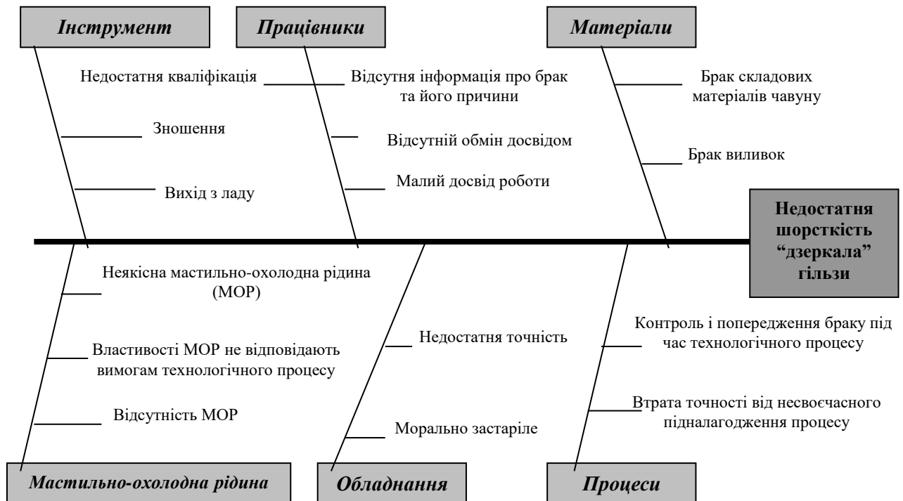
Рисунок 3.5 Діаграма Ісікави щодо визначення проблеми недостатньої шорсткості “дзеркала” гільзи
